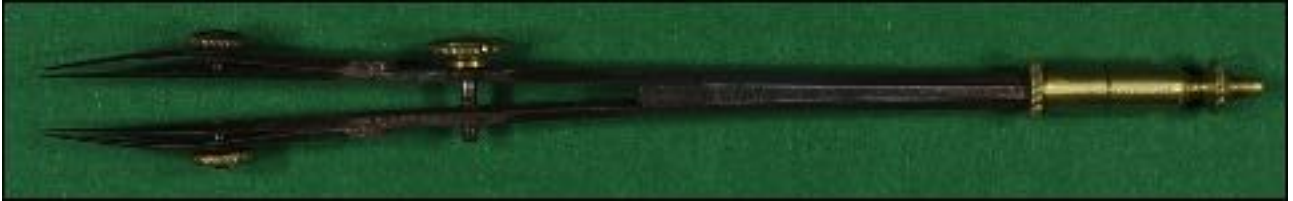
Tire-ligne anglais double (rail-road) en laiton et acier, 128 mm.
