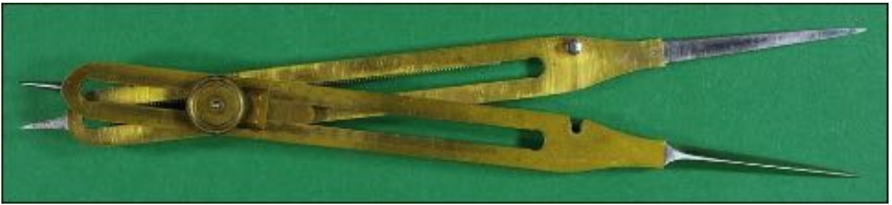
Compas de réduction RENAUD, 200 mm, mécanisme de réglage à crémaillère.
