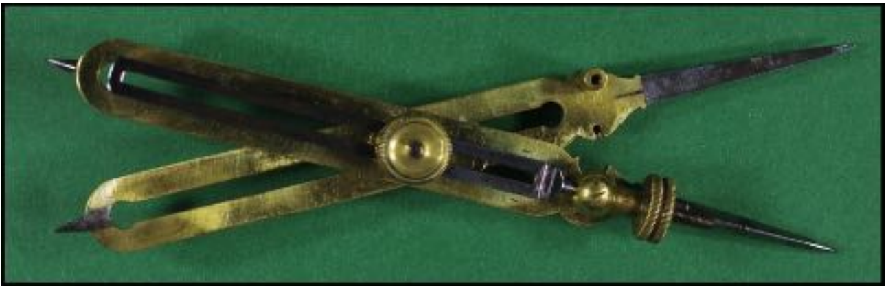
Compas de réduction à mécanisme de réglage. Signé GARDNER & NEILL, BELFAST
