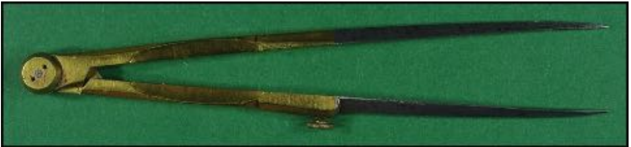
Grand compas à pointes sèches en laiton et acier (170 mm)
