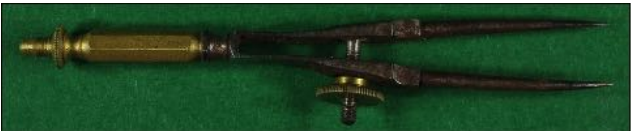
Petit compas à pointes sèches, laiton et acier (70 mm)
