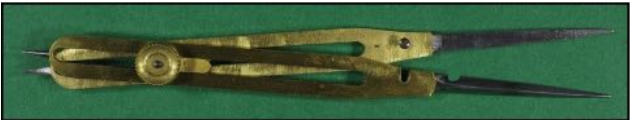
Compas de réduction simple en laiton et acier
