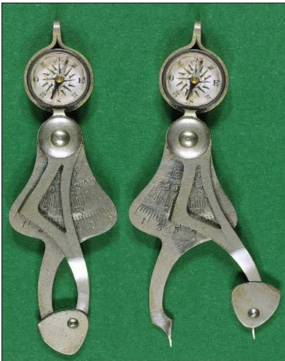
Compas de marche inventé par Otto PETERMANN et Conrad JUCKER . Avec une boussole. le brevet suisse de 1899 N° CH20093A le designe comme Militärzirkel.
