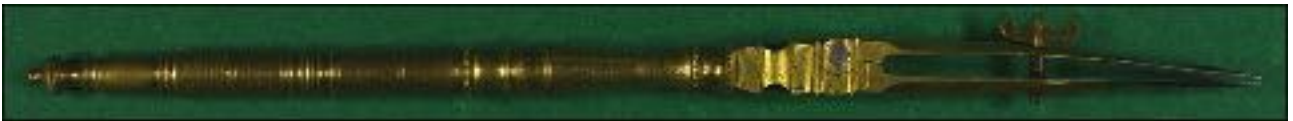
Tire-ligne anglais ancien (vis papillon) datant probablement de la fin du 18 e siècle.
