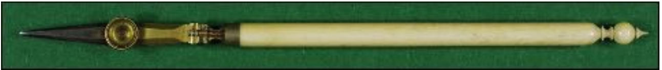
Un autre tire-ligne anglais en laiton et acier, manche en os, 140 mm.
