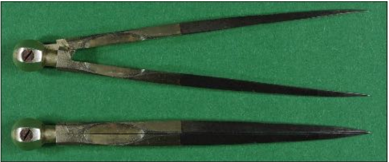
Compas à pointes sèches à tête sphérique en cupronickel et acier (127 mm)
