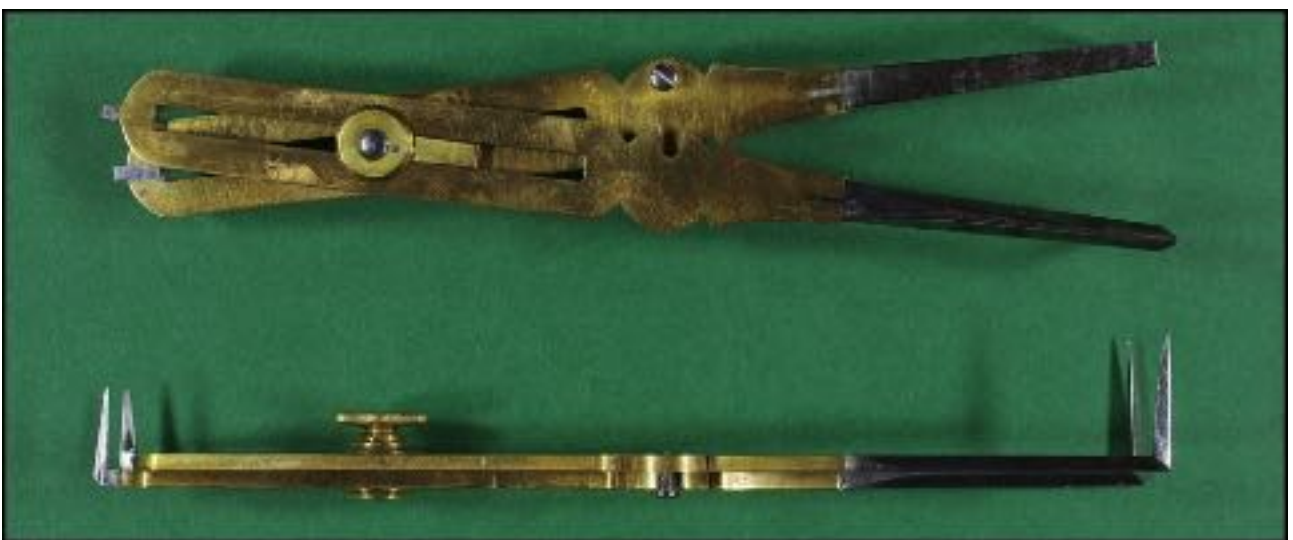
Compas de réduction en laiton et acier à pointes repliées à angle droit
