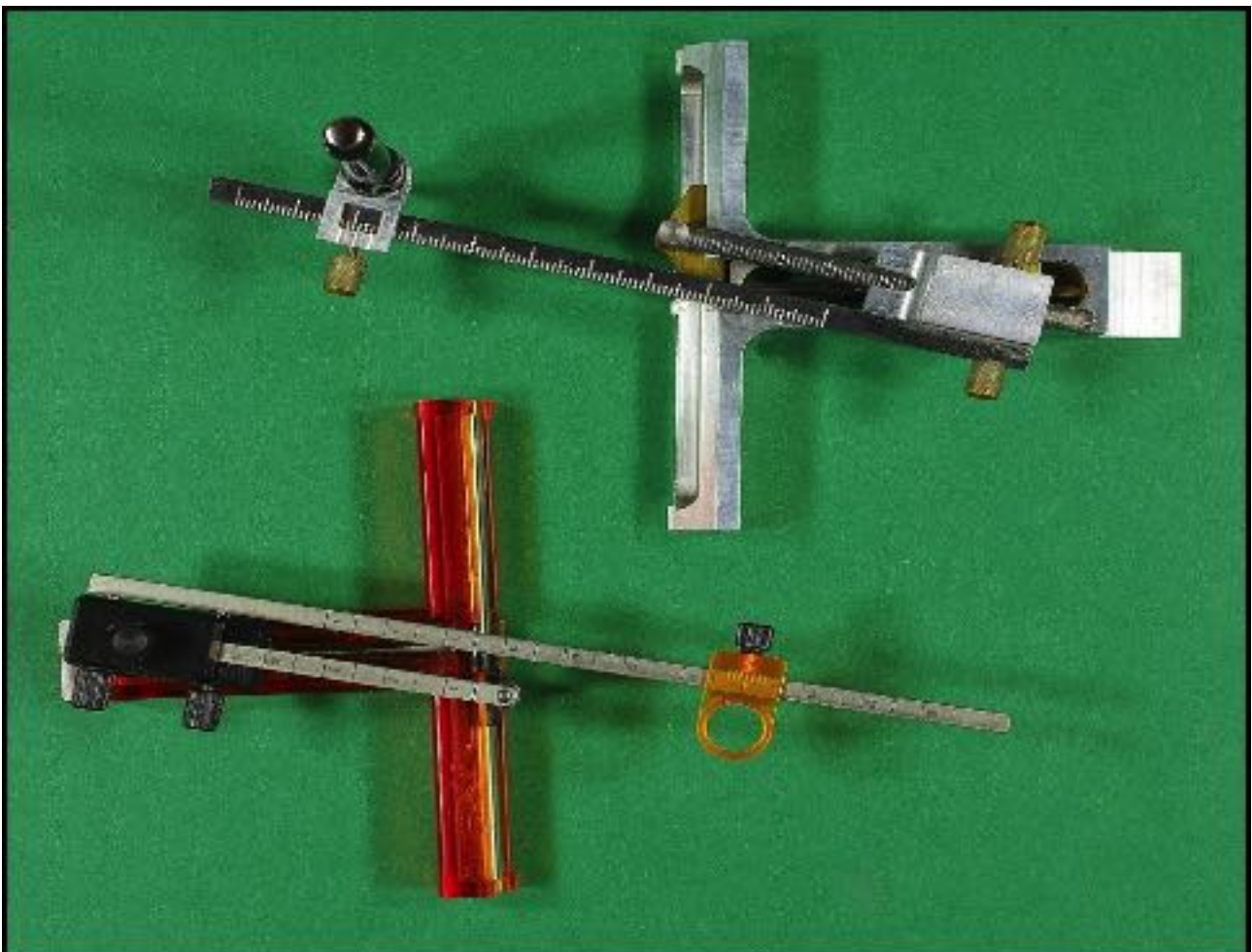
Deux ellipsographes MAGNAT, l'un en plexiglas et métal, l'autre entièrement en métal. Brevet français N° 76 09426 de 1976 déposé par Pierre Magnat. La longueur graduée du bras traceur est de 10 cm.
