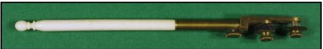
Un pointillleur d'origine inconnu, l'alimentation en encre de la molette traçante s'effectue par l'intermédiaire d'un disque en feutre imbibé d'encre.
