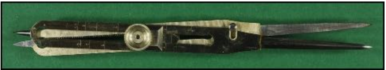
Compas de réduction DARNAY, mécanisme de réglage à crémaillère.
