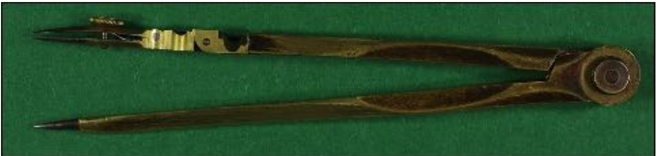
Compas à encre HARLING LONDON, laiton et acier, (126 mm)
