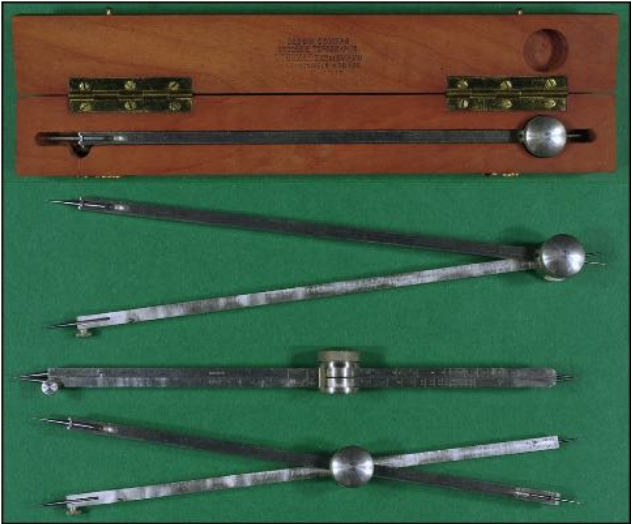
Compas de réduction BARABAN (étui bois marqué L. THOMAS Suc. de Baraban) 20 cm. Le système original de l'axe de réglage permet de l'utiliser aussi comme un grand compas à pointes sèches.
