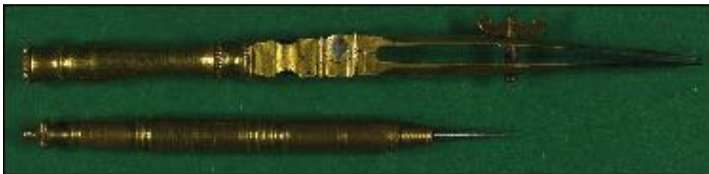
Un autre tire-ligne d'origine anglaise, le manche est fixe.
