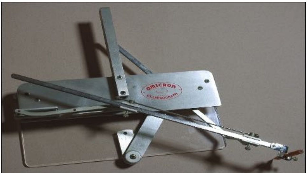
Ellipsographe OMICRON 25. Le bras traceur mesure 40 cm, la différence entre les deux axes de l'ellipse peut atteindre 19 cm.
