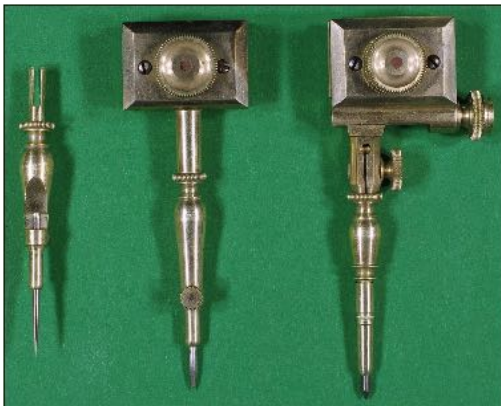
Compas à verge français, (probablement fabriqué par Renaud-Tachet), datant de la période 1850/1900.
