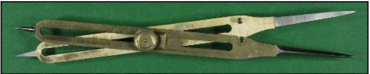
Compas de réduction RENAUD-TACHET, mécanisme de réglage à crémaillère.
