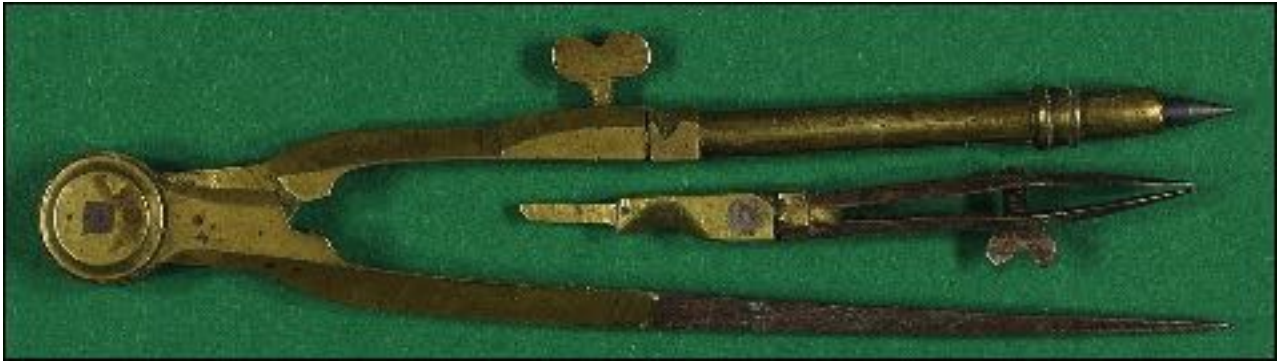
Compas à vis papillon et ses brisures porte-mine et encre. Dix-huitième siècle, laiton et acier, 105 mm.
