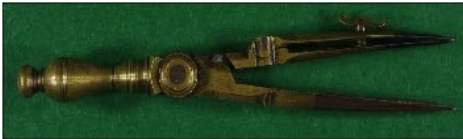
Un autre petit compas anglais à encre, laiton et acier, vis papillon (76 mm) datant probablement de la fin du 18 e siècle.
