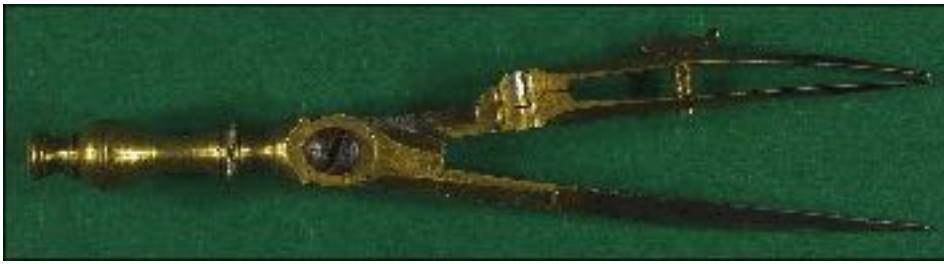
Petit compas anglais à encre, laiton et acier, vis papillon (80 mm) datant probablement de la fin du 18 e siècle.
