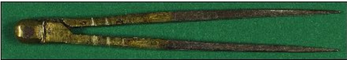
Compas à pointes sèches dix-huitième siècle, laiton et acier, 90 mm, tête à facettes.
