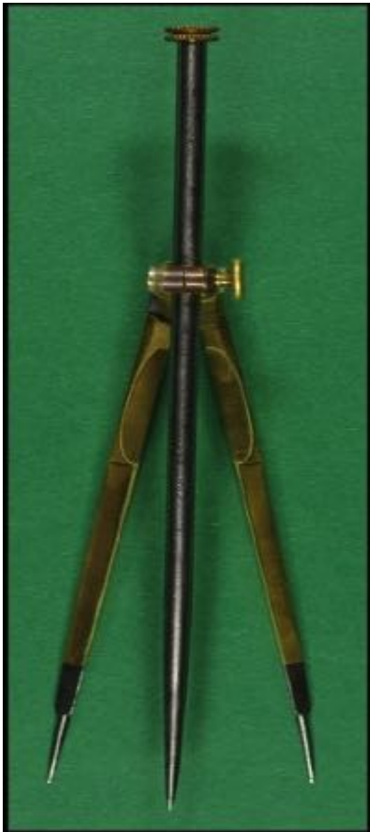
Compas à trois pointes, non signé, qui est assez semblable à des modèles fabriqués dans les années 1900.
